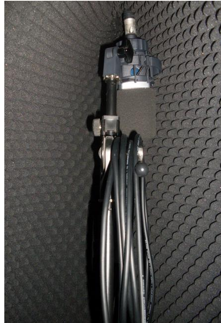
Hier wurde aus Akustikschaumstoff eine Art Zipfelmütze genäht, die über einen Mikrofonständer gesetzt wurde. Mit Hilfe eines Gürtels hält es am Mikrofonständer. Der Sprecher platziert sich unter die Mütze. Die Aufnahmen sind relativ gut gedämpft und enthalten auf Grund der Form relativ wenig bis gar keinen Raumhall mehr.
